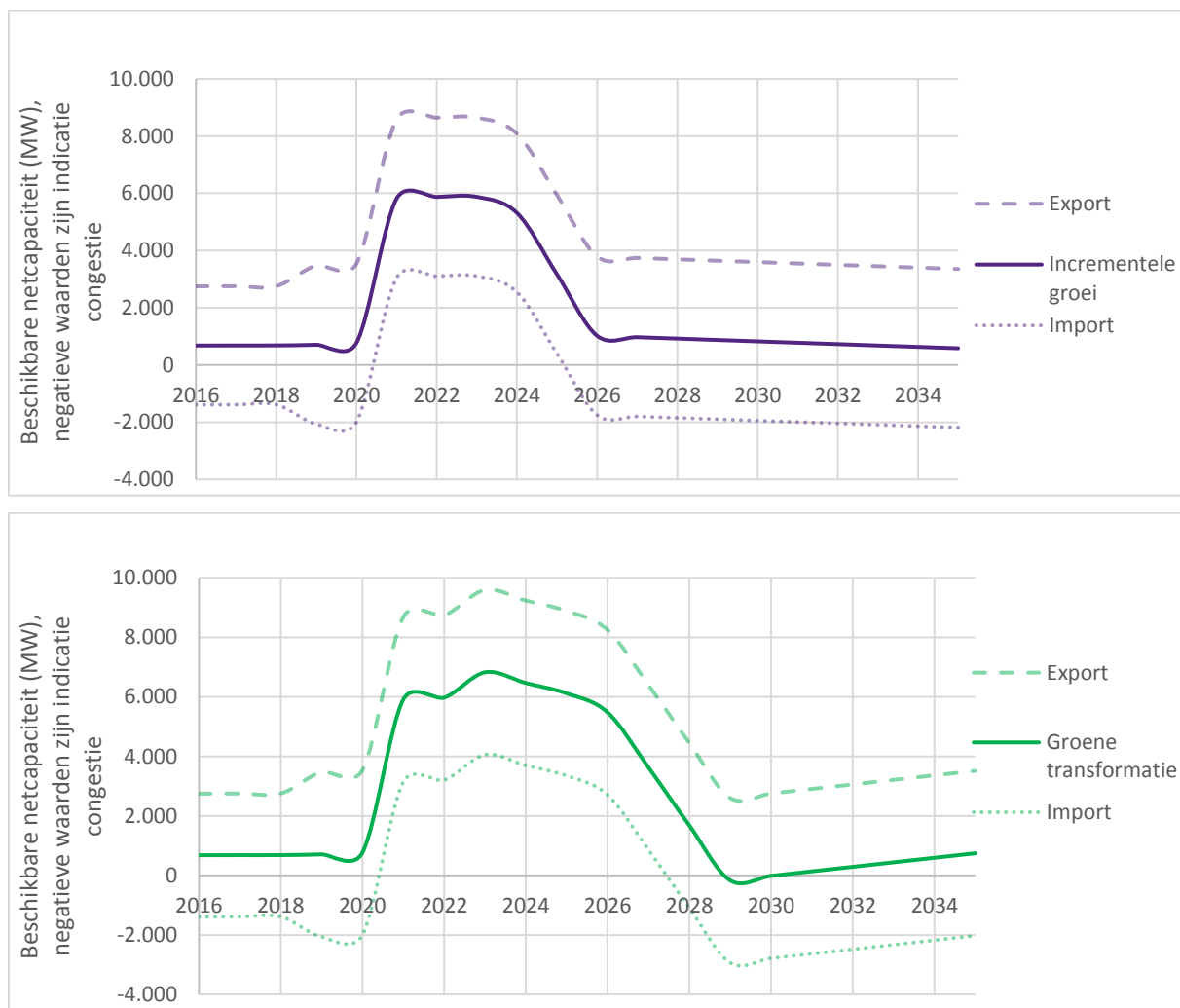
Figuur 3: Verwachte beschikbare netcapaciteit in 3 toekomstscenario's (boven "Business as usual" met 7 GW offshore wind, midden "Incrementele Groei" met 5 GW offshore wind, onder "Groene transformatie" met 11 GW offshore wind)
